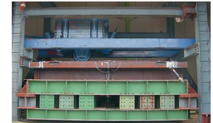
中間支点上を対象とした縮小モデルの一定荷重載荷輪荷重走行試験
