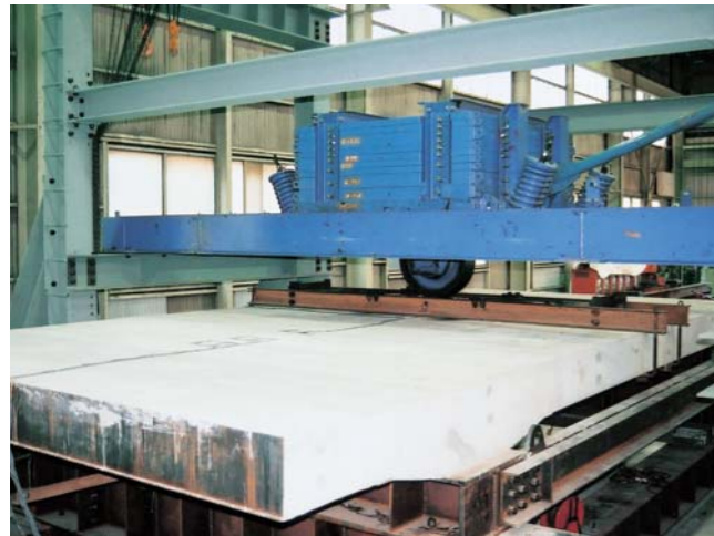
輪荷重走行試験 (床版支間5,200mm)
