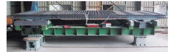
実大モデルのせん断試験
