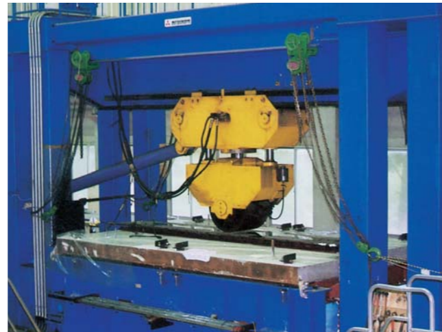
輪荷重による床版のたわみ
