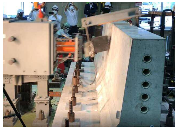
写真 1 通信管路を配置したラピッドガードフェンスの衝撃試験状況
