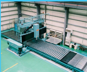
大型 5面加工機 (テーブルサイズ 3,500×8,000mm)
