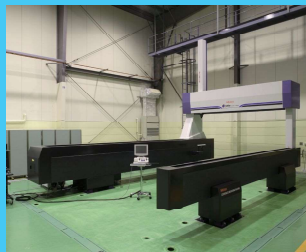
超大型三次元測定機(ミツヨ社製) (測定範囲 3,000×6,000×2,000mm)
