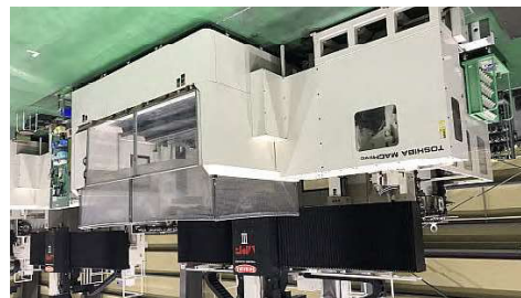
小型精密5面加工機(テーブルサイズ1,600×2,800mm)
