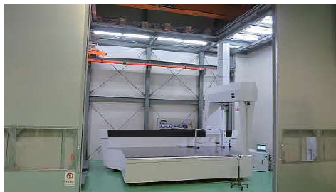
超精密三次元測定機(カルツァイス社製) (測定範囲 2,100×4,400×1,600mm) ※精密空調 23℃±0.3℃
