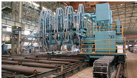
10電極自動溶接装置
