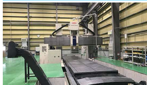
大型5面加工機(テーブルサイズ3,100×8,000mm)
