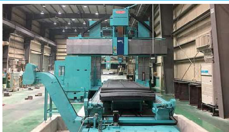
精密5面加工機(テーブルサイズ2,000×5,000mm)
