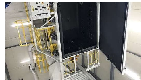
自動プラスト機(プラスト可能サイズφ2000×2500mm)
