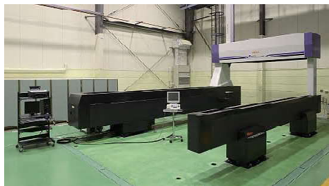
超大型三次元測定機(ミツトヨ社製) (測定範囲 3,000×6,000×2,000mm)
