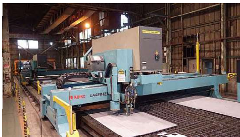
NCレーザー切断機 (6kW)
